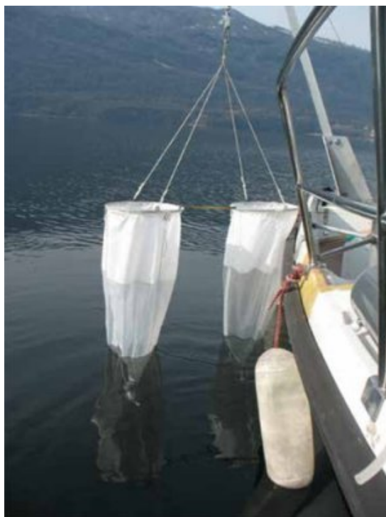
Photo 4 - Filet de vide de maille de 200 \mu\text{m} utilisé pour l'échantillonnage du zooplancton : les prélèvements sont réalisés lors de traits verticaux depuis 50 m de profondeur jusqu'à la surface (© CISALB)
