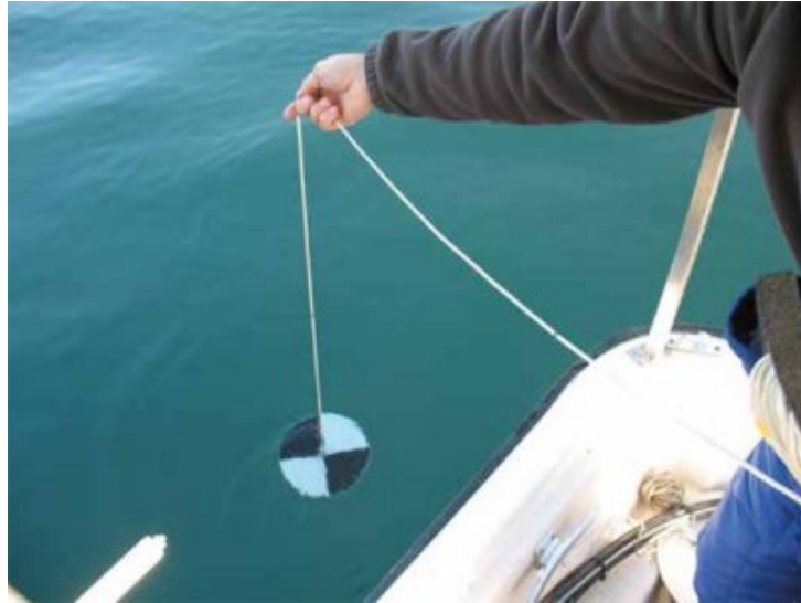
Photo 1 - Deux types de disque sont utilisés : soit un disque blanc de 30 cm de diamètre, soit un disque noir et blanc de 20 cm de diamètre (protocole DCE) (© D. Zanella - SILA)
