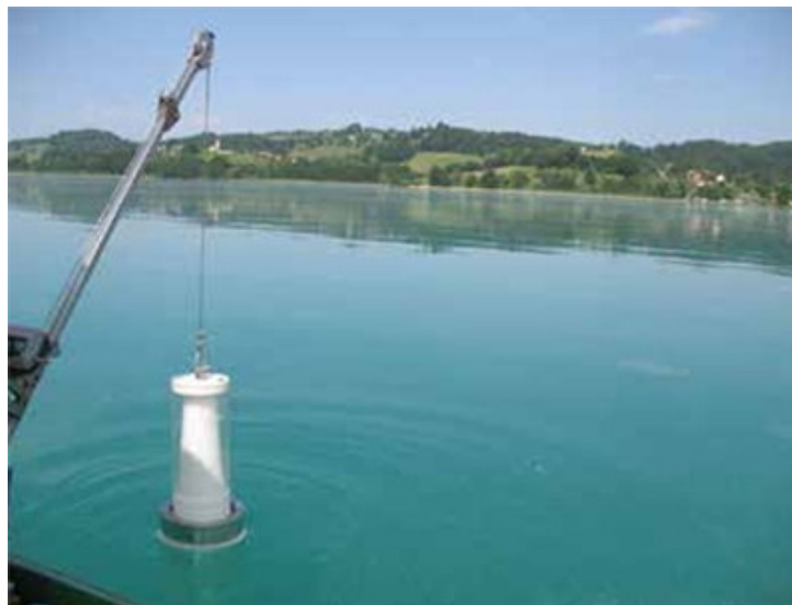
Photo 3 - Prélèvement intégré : la cloche se remplit progressivement lors de la descente le long de la colonne d'eau. Au cours de la remontée, sous l'effet de la pression, une valve ferme la bouteille (© DREAL Rhône-Alpes)
